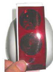
Figure 11 : Placement du filtre de simulation de l'alarme feu
